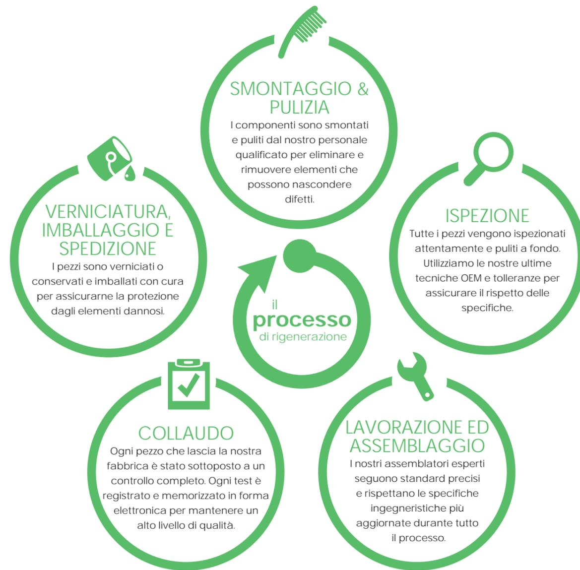
I nostri pezzi rigenerati devono funzionare perfettamente con gli altri componenti OEM, per migliorare le prestazioni e limitarne l'usura. Per questo i nostri tecnici specializzati ricondizionano, ispezionano attentamente e sottopongono a test tutti i pezzi di ricambio rigenerati, per accertarsi che soddisfino tutti gli standard e tutte le specifiche di INNIO.
