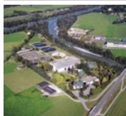
シュトラス・イム・ツィラータールに本拠を置くAchtal-Inntal-Zillertal (AIZ) 下水道協会は、廃水処理場で2基の下水ガス燃焼イェンバッハJ312エンジンを使用して、熱電併給 (CHP) システムを稼働させています。このシステムは、プラントの環境フットプリントを改善し、エネルギーの移行に貢献しています。処理プラントでは、1日当たり28,270立法メートルの廃水を浄化しています。
