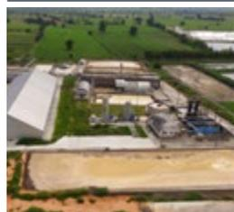
Fünf biogasbetriebe Jenbacher J420 Motoren erzeugen mehr als genug elektrische Energie, um die Tapiokastärkefabrik der Chok Yuen Yong Industry Co., LTD zu versorgen. Der überschüssige Strom – rund 1.000 kW – wird in das öffentliche Netz eingespeist, wodurch sich die Stromkosten der Fabrik noch weiter reduzieren.
