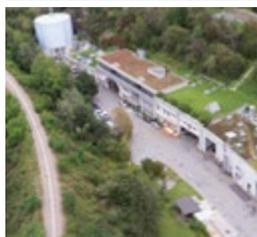
ARA Pustertal の Tobi プラントは、サン・ロレンツォの Pflarenz/ Tobi 地域の約15万8,000人の廃水を毎年処理しています。2022年には、215万立方メートル以上の下水ガスが生産され、イエンバッハ J208の熱電併給 (CHP) ユニット3基の動力源として使用され、発電所の年間電力需要の83%を満たしました。また、排気ガスの熱をプラント内の下水汚泥の乾燥に利用しています。
