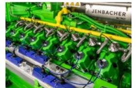
E.ONの会社であるHanseWerk Naturは、ハンブルグで主力製品のCHPプロジェクトを紹介しています。1 MW Jenbacher J416はパイプラインガスの運転および高い総合効率で最適化されています。2020年に、INNIO JenbacherとHanseWerk Naturはパイプラインガスから100%水素運転への現地での仕様変更を実施しました。このエンジンは、0%から最大100%まで (H<sub>2</sub> 100%は短期間のデモ運転用) の可変水素混合で走行します。これは当社のJenbacherタイプ4エンジンが水素だけで運転でき、既存のエンジンからH<sub>2</sub> 100%への仕様変更を実現できるという確かな証拠です。
