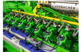
E.ON 公司旗下 HanseWerk Natur 能源站在汉堡市展示了一个热电联供旗舰项目。1 MW 颜巴赫 J416 经过优化，以实现天然气运行，并提高总体效率。2020 年，INNIO 颜巴赫和 HanseWerk Natur 能源站现场演示了将天然气转换为 100% 氢气运行。该发电机组以 0% 到 100% 的氢气/天然气混合气体为燃料运行 (在短期演示运行中使用了 100% 的氢气)。这一点有力地证明了我们的颜巴赫 4 系列发电机组可完全依靠氢气运行，同时还证实了现有发电机组也可使用 100% 氢气运行。
